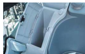
Caja con función de ventilación del aire acondicionado
