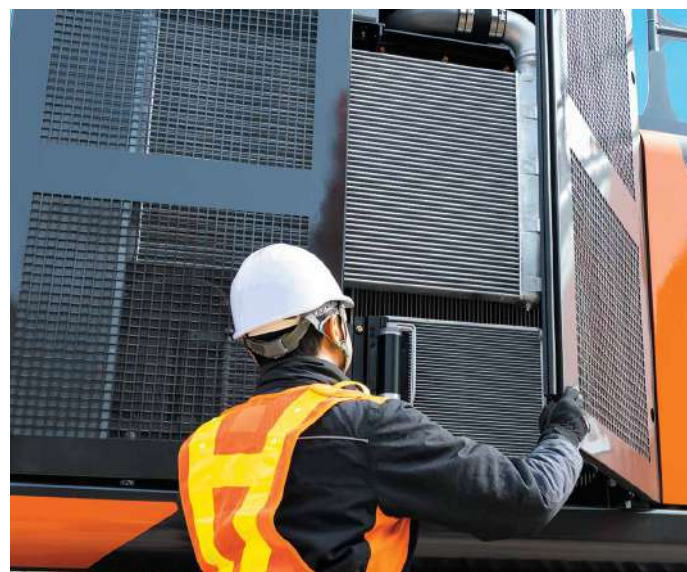
Red a prueba de polvo en la funda lateral derecha
