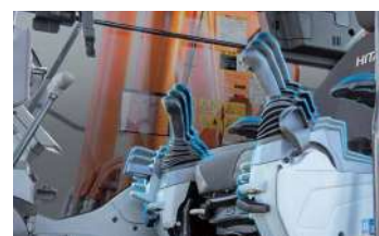
Ajuste de la altura de la consola sin herramientas
